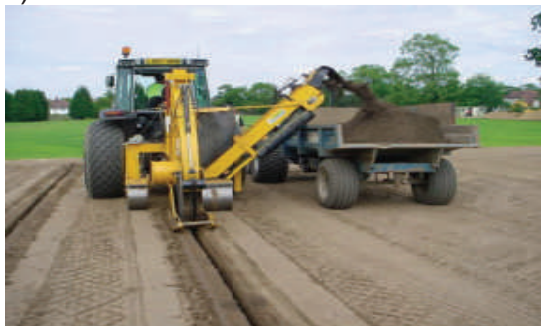
Сл.9.7.Механизиран плуг со нож и работен цилиндер со заострен врв,
